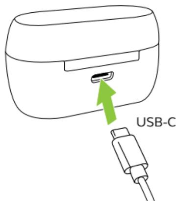
Nous vous recommandons d'utiliser une source d'alimentation électrique de 5V +/-0,25V avec une intensité de recharge inférieure à 24. Nous vous déconseillons de recharger les écouteurs-boutons ou l'étui-chargeur avec une alimentation électrique affichant une tension supérieure.
