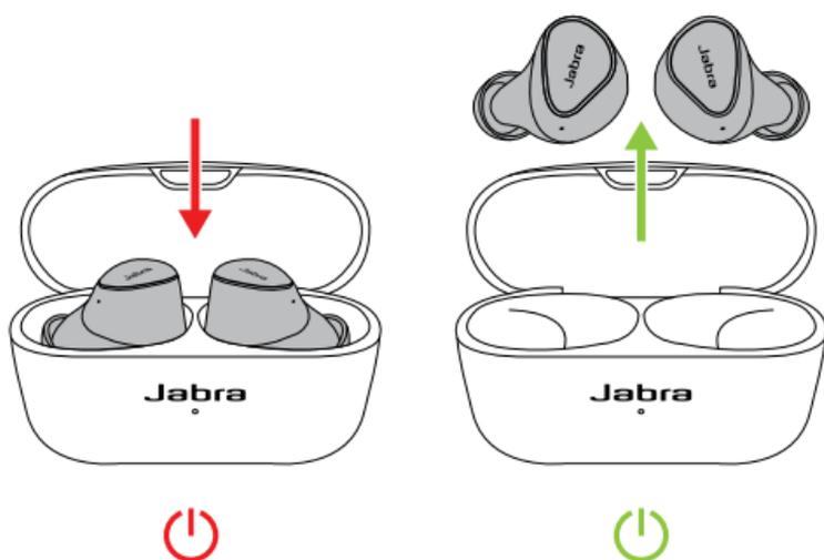
Pour éteindre manuellement vos écouteurs, appuyez sur les boutons **gauche** et **droit** simultanément, ou appuyez pendant 5 secondes sur le bouton **gauche** ou **droit** si vous êtes en mode mono.
