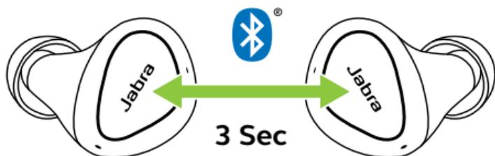
1. Allumez les écouteurs-boutons en les retirant de l'étui-chargeur. Autrement appuyez sur les boutons **gauche** et **droit** pour allumer les écouteurs-boutons.
